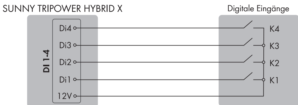
Abbildung 10: Anschluss eines Fernwirkgeräts am digitalen Eingang DI D1-D4, Vcc des Sunny Tripower Hybrid
